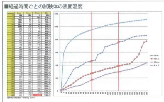
20mmの膜厚で作成した試験体は
