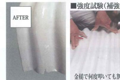
強度試験(補強工法) 金槌で何度叩いても割れない
