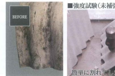
強度試験(未補強) 簡単に割れてしまう スレートのアスベスト問題が...
